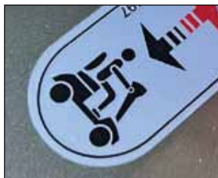
Vrijloophendel omlaag: - elektrische rij-stand - rem is WEL ingeschakeld!
