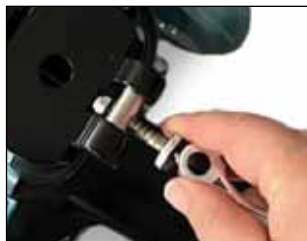
2. Goupille de verrouillage rétractée
