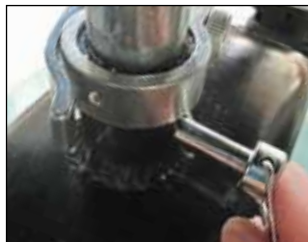
3. Insérer la goupille de verrouillage
